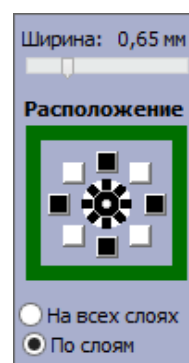
Рис. 67. Послойная настройка термобарьеров
