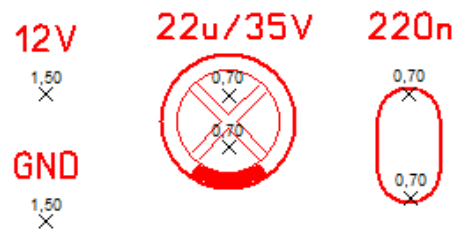
Рис. 108. Обозначение центров отверстий
