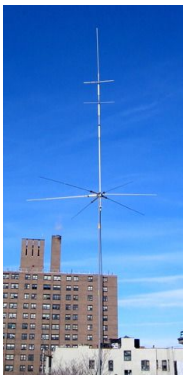
Рис.2.9. Антенна «Diamond CP-6»
